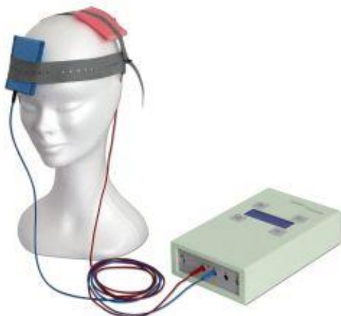
tCS apparaat met een voorbeeld hoe de elektroden op het hoofd kunnen worden geplaatst.
