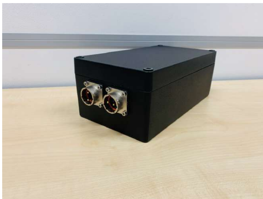
Figuur 21: Dit is de nieuwe charge controller in de behuizing die ik samen met de heer Hahn heb vormgegeven. De behuizing is volledig water- en stofdicht. Alle onderdelen hebben een classificatie van IP66 of hoger. Aan de voorzijde zijn de twee connectoren voor de accu en het zonnepaneel bevestigd. Deze zijn volledig met metaal afgeschermd.
