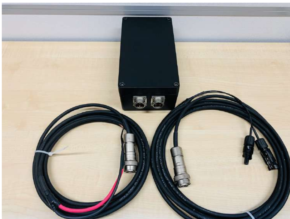
Figuur 23: Op deze foto zijn ook de bijbehorende kabels weergegeven. Ook de kabels zijn volledig afgeschermd door middel van een vlechtwerk in de kabels. De stralingsbescherming loopt op deze manier helemaal door tot aan de connectors van het zonnepaneel en de batterij.
