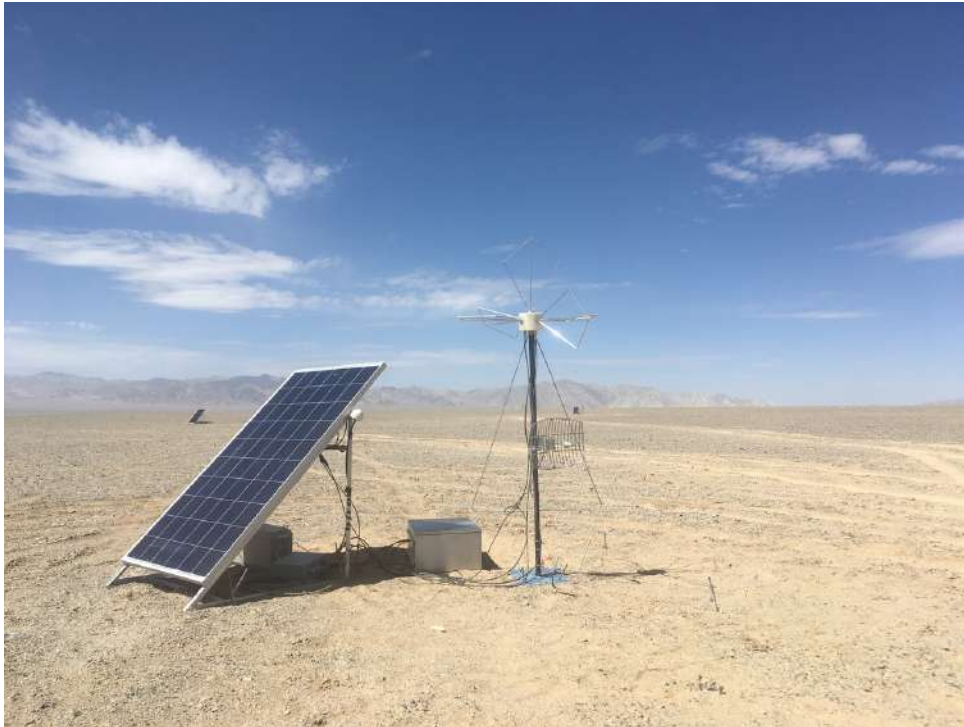
Figuur 17: Dit is een foto van de prototype antenne's zoals die nu in China staan. Links zien we het zonnepaneel en rechts de antenne. Onder het zonnepaneel is de accu geplaatst. Tussen de antenne en het zonnepaneel ligt de digitizer op de grond.
