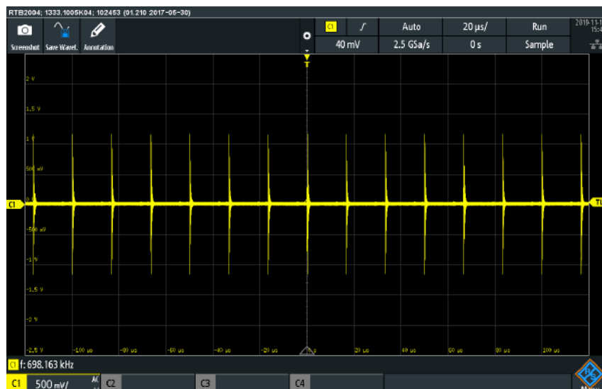
Figuur 19: Hier zijn de gemeten pulsen weergegeven van de charge controller tijdens het opladen van de batterij bij een aanvoerspanning van 19 V en aanvoerstrom van 1 A. De lus is hier direct naast de charge controller geplaatst.
