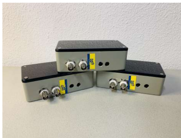
Figuur 14: Dit zijn de drie bias-T's die ik zelf heb gemaakt. De componenten en connectoren heb ik gesoldeerd op een printplaat. Vervolgens heb ik de printplaat in een afgesloten plastic behuizing geplaatst. Het bijbehorende schakelschema is afgebeeld in figuur 15.
