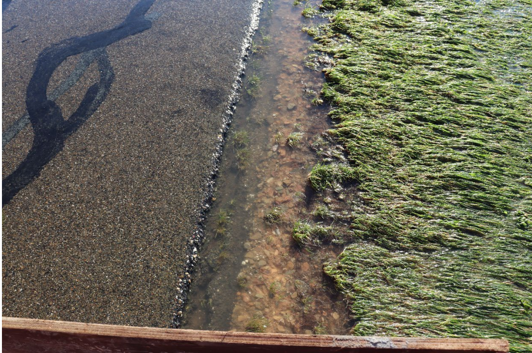
Figuur 12: Erosie bij de scheiding tussen asfalt en bodem na overslagproeven op locatie 48.
