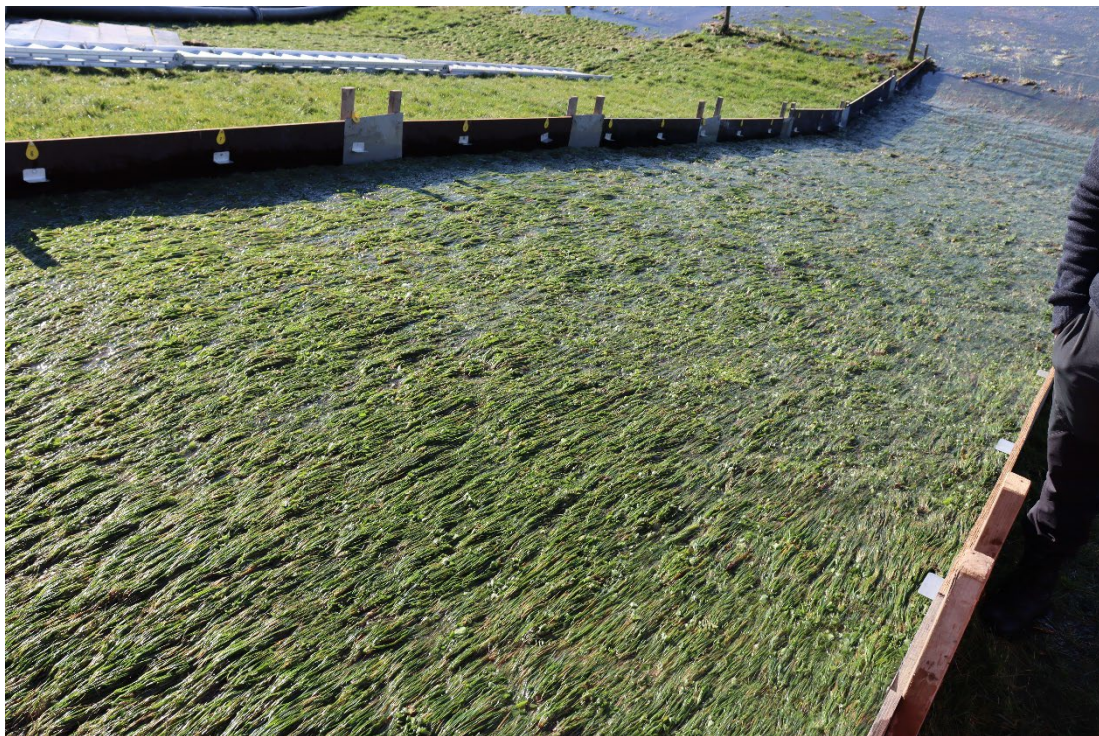
Figuur 13: Dakpaneffect van gras na overslagproeven op locatie 48.
